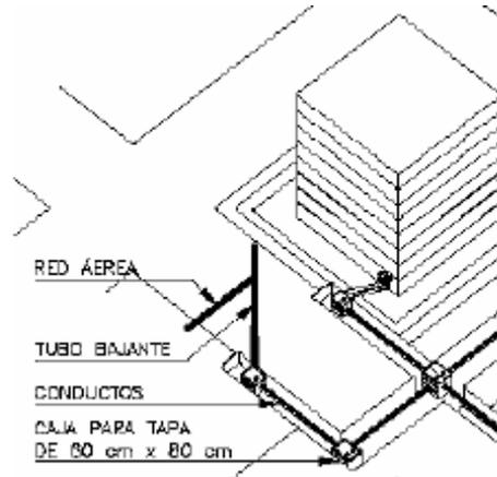
SISTEMA DE TIERRA: ESTA ES UNA SUPERFICIE BAJO TIERRA, LA CUAL SIGUIENDO LAS NORMAS ESTIPULADAS PARA EL ATERRIZAJE PRINCIPAL DE EDIFICIOS, POSEE UNA MALLA Y UN TIPO DE TIERRA ADECUADO A FIN DE LOGRAR UN SISTEMA A TIERRA DE ÓPTIMA CALIDAD. ESTE SISTEMA HA SIDO ELABORADO BAJO ESTRUCTAS
